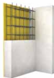
odlévání druhé části konstrukce
