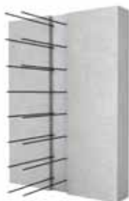
armování druhé části konstrukce
